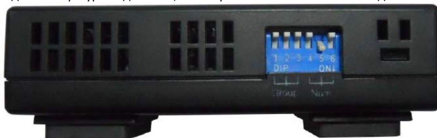
Figure 8-13 DIP выключатель температурного датчика
