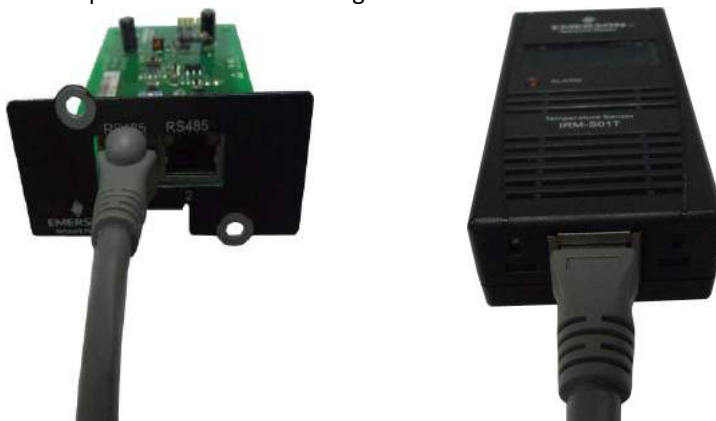
Figure 8-12 Соединение карточки UF-RS485 и температурного датчика батареи
